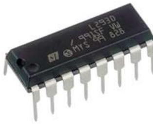
**VS (Vcc2)** 馬達外接電源 4.5 V ~ 36V
