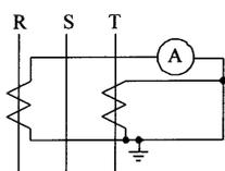
25. (2) 如下圖所示，電流表  $A_2$  指示之電流為 ①R 相 ②S 相 ③T 相 ④零相。
