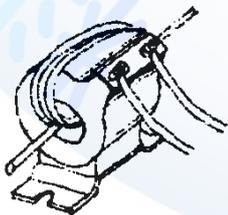
24. (1) 如下圖所示，電流表 A 指示 ①R 相電流 ②S 相電流 ③T 相電流 ④零相電流。
