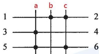
4. (3) 如下圖所示，X 電驛之動作為 ①能 ON 能 OFF ②不能 ON 亦不能 OFF ③能 ON 但不能 OFF ④不能 ON 但能 OFF。
