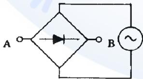
91. (1) 二極體施加順向偏壓的方法，則 ①於 P 極加正電壓，N 極加負電壓 ②於 N 極加正電壓，P 極加負電壓 ③兩極皆加正電壓 ④兩極皆加負電壓。
