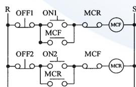
8. (2) 如下圖所示，當 ON 及 OFF 按鈕開關同時押下時，電磁接觸器 MC 之線圈 ①不一定動作 ②動作 ③電路短路 ④斷續動作。
