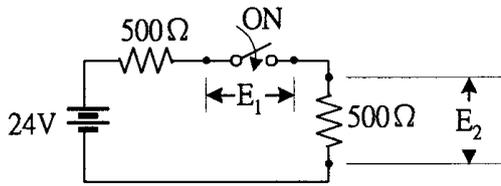
117. (4) 如下圖所示，單切開關 OFF 時， $E_1$ 、 $E_2$  的電壓降分別為 ① $E_1 = 12V$ 、 $E_2 = 12V$  ② $E_1 = 0V$ 、 $E_2 = 12V$  ③ $E_1 = 0V$ 、 $E_2 = 24V$  ④ $E_1 = 24V$ 、 $E_2 = 0V$ 。
