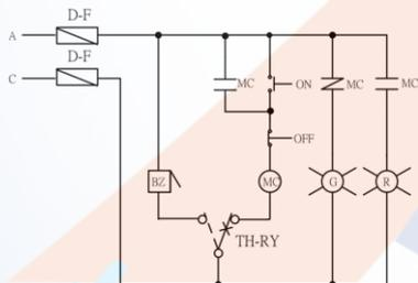
12. (2) 如下圖電路所示，按下按鈕開關 ON 後，則 ①指示燈 G 亮 ②指示燈 R 亮 ③X 激磁後，控制電路將短路 ④指示燈 R 及 G 均不亮。
