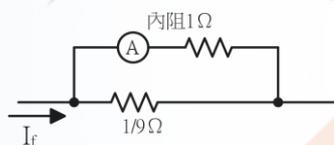
30. (2) 如圖
