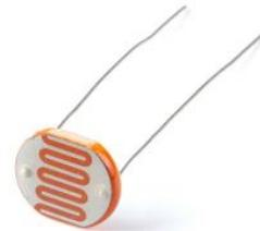
圖 11 光敏電阻 (CDS-10mm)
