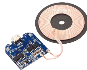
圖 14 5V 1A 無線充電發射模組
