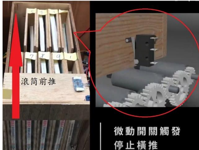
圖 34 滾筒直向帶動向前推動
