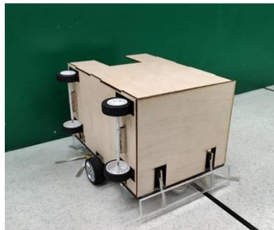
圖 45 吸塵車側面加裝輪胎
