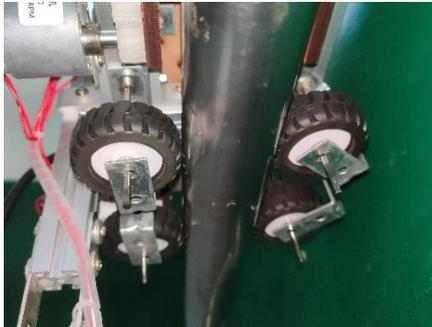
圖 43 吸塵車側面加裝輪胎
