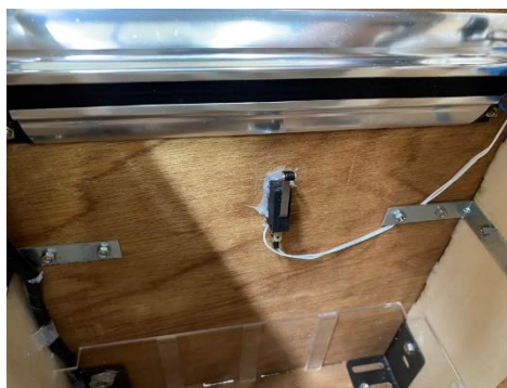
圖 50 電熱絲下方微動開關
