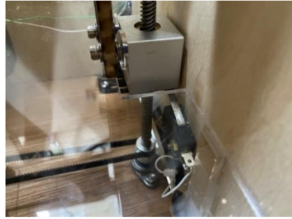
圖 47 螺桿底部微動開關
