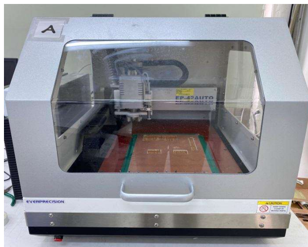
圖 33 電路板雕刻機
