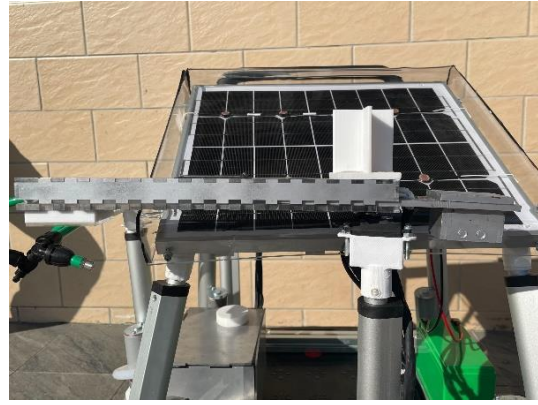
圖 45 配重後 LED 燈桿保持平衡
