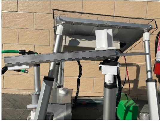
圖 44 配重前 LED 燈桿前端下垂
