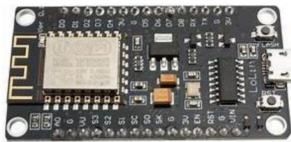
圖 13 ESP8266 開發板(NodeMCU)
