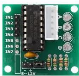
圖 12 步進馬達驅動模組(ULN2003)
