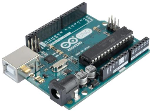
圖 3- 4 Arduino Uno 板
