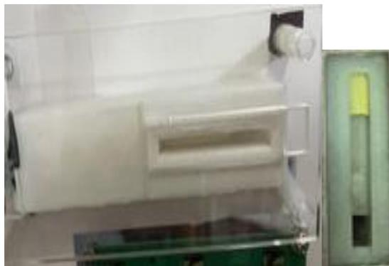
圖 22 硬幣投入口背面/正面
