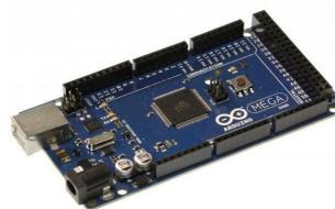
圖 15 Arduino mega2560 板
