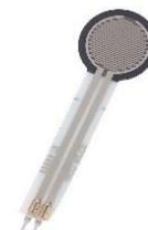
圖 12 壓力感測器
