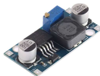
圖 19 DC-DC 降壓模塊
