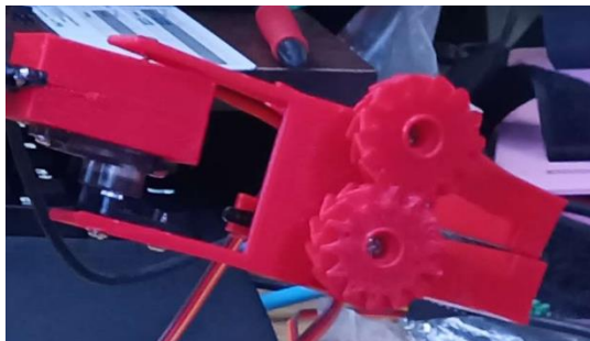
圖 65 馬達並非直接與齒輪接合
