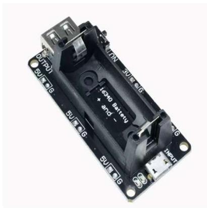
圖 9 16340 鋰電池充電/供電電源模組
