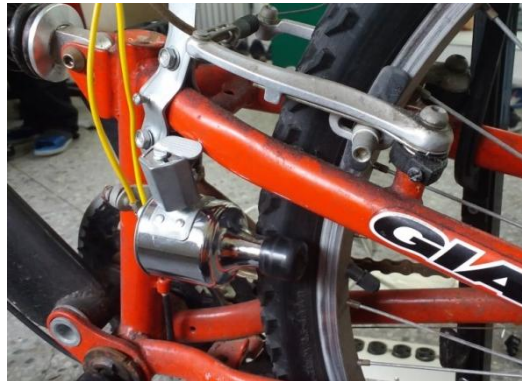
圖 11 交流永磁式摩電機
