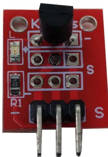
圖 7 溫度感測元件
