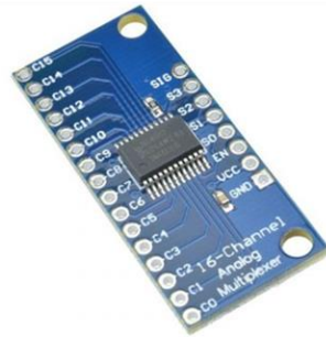
圖 18 CD74HC4067 類比多工器
