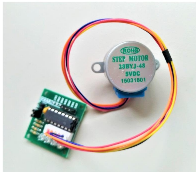
圖 7: UL2003 電機驅動板+5V 步進馬達
