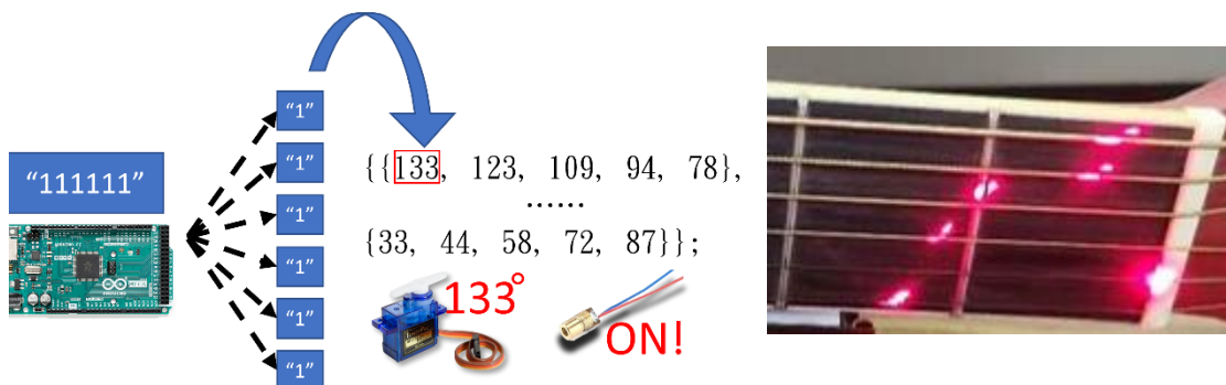
圖 28 Mega 2560 程式邏輯及雷射光點動作
